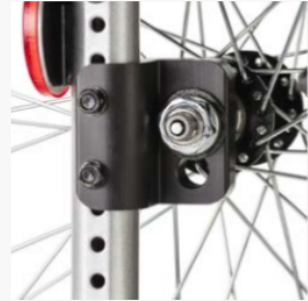
Wielbasisverlenging door varioblok naar achter te draaien
