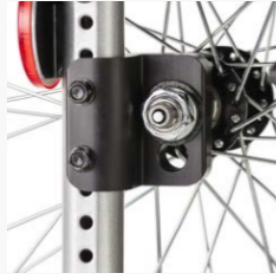
Radstandsverlängerung durch Drehen des Varioblockes nach hinten
