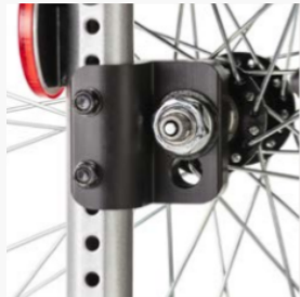
Wielbasisverlenging door varioblok naar achter te draaien
