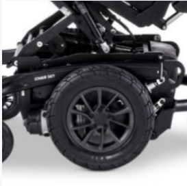
Midwielaandrijving voor maximale wendbaarheid en nauwkeurig manoeuvreren
