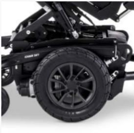
Mittelradantrieb für größte Wendigkeit und präzises Manövrieren
