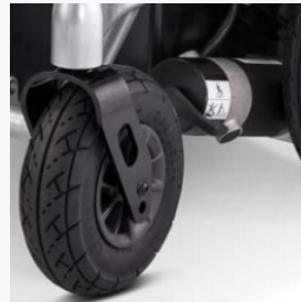
Roues directrices avec jante en aluminium
