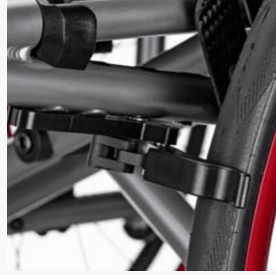
Innovatieve lichte rem zwenkbaar uit aluminium
