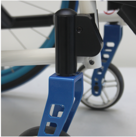
Bis zu 12° Sitzneigung für feinstufige Anpassungsmöglichkeiten
