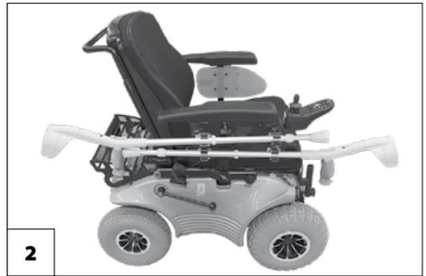
Zum Mitführen der Gehhilfen sind diese in jeweils zwei Klammern des Gehhilfenhalters zu drücken.
