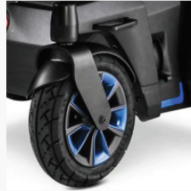
Die neuentwickelte Einzelradfederung (4-fach)
