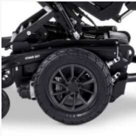
Mittelradantrieb für größte Wendigkeit und präzises Manövrieren
