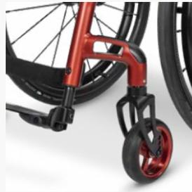
Lenkradanbindung aus Vollmaterial
